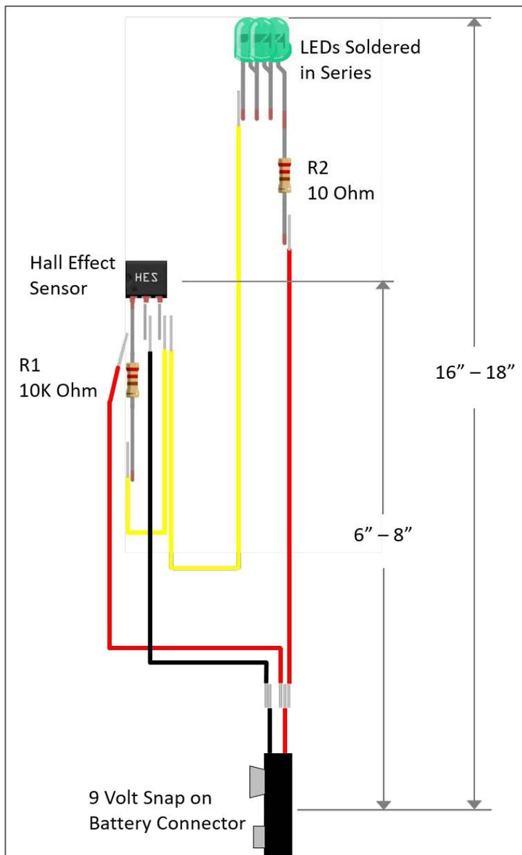
*Figure 1.11. Wiring Illustration*
