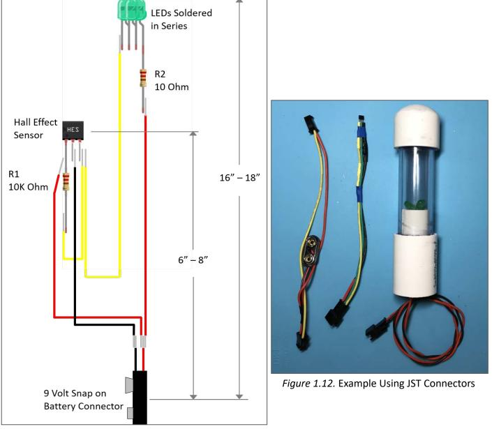
Figure 1.11. Wiring Illustration
